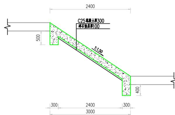
腰坝水库溢洪道尾水渠维修剖面图 1:50
